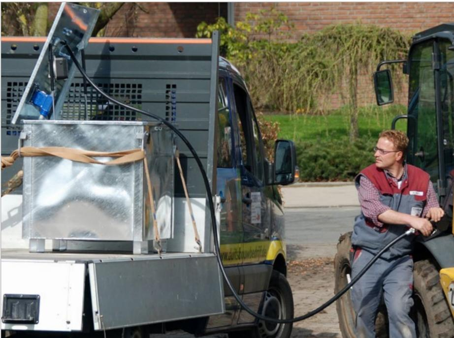
**Mobiler, einwandiger Tank für die Versorgung von Bau- und Arbeitsmaschinen. Zulässig für den Transport zum unmittelbaren Verbrauch nach ADR 1.1.3.1 c)**
