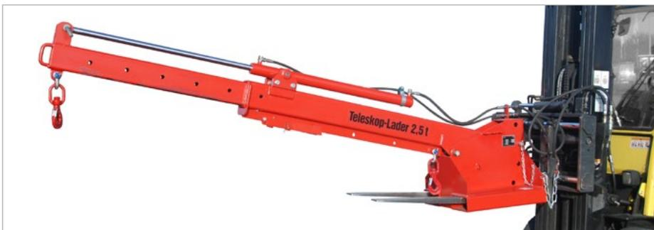
Hydraulisch teleskopiert (KTH)
