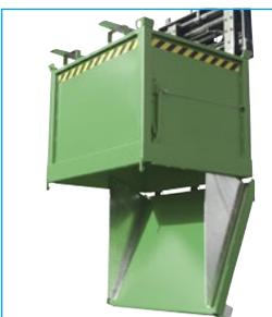
Behälter mit Bodenklappen bieten bei der kompakten Bauform ein optimales Füllvolumen, und durch den günstigen Lastschwerpunkt ist eine volle Ausnutzung der Staplertragfähigkeit möglich. Der große Öffnungsbereich der einteiligen Bodenklappe bietet dabei eine vollständige Entleerung auch bei sperrigem Material mittels Zugseilentriegelung.
