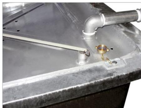
Peilstab zur Füllstandskontrolle
