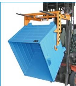
Diese Behälter haben keinen integrierten Kippmechanismus und sind somit eine preiswerte Alternative. Unabhängig von der eingesetzten Behälterstückzahl ist bei identischer Breite der Behälter nur eine Entleertraverse für den Kippvorgang erforderlich. Für die Behälter ohne Aufnahmezapfen wird ein vorhandenes Drehgerät am Gabelstapler zur Entleerung vorausgesetzt.
