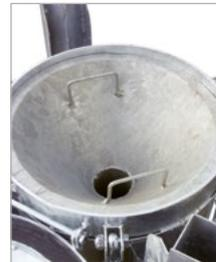
Trichter mit Füllrohr
