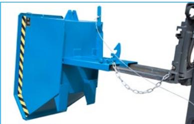
Die kompakte Bauform und geringe Bauhöhe bietet ein optimales Füllvolumen und gewährleistet durch den idealen Kippwinkel immer eine vollständige Entleerung. Der Kippvorgang erfolgt schnell und wird mittels Zugseilentriegelung ausgelöst. Ebenso ist es möglich, die Behältermulde vor dem Entriegeln auf den Behälterrand aufzusetzen und langsam durch Hochfahren des Hubmastes zu entleeren.
