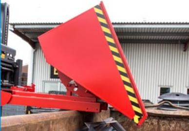
Neben dem Abrollsystem haben diese Behälter noch eine automatische Entriegelung. Durch Aufsetzen auf oder durch Druck gegen den Containerrand wird der Behälter entriegelt. Das Handling mit dem Zugseil entfällt.
